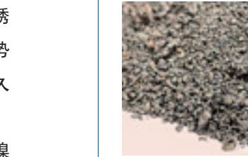
冰镍为动力电池主要材料之一，因应全球电动车产业兴起，动力电池用镍需求持续提升。华新丽华透过 RKEF 镍生铁转制冰镍之工艺跨入电池镍供应链，进一步深耕镍资源产业。未来在面对电池产业链持续蓬勃发展时，将使生产与销售上保持高度竞争力。
